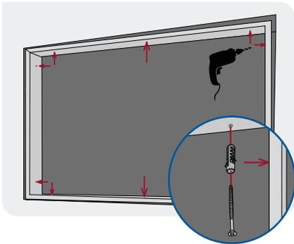
**9** • Legen Sie die Position der Löcher für die Befestigung des Rahmens an der Wand fest.
